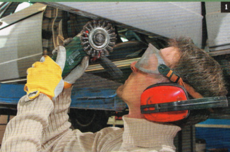
1 Mit der harten Zopfbürste lässt Michael Platz Rost und Lack davonfliegen. Radikales Freilegen ist der erste Schritt jeder Sanierung
