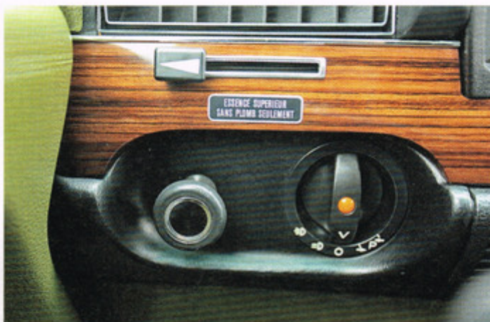
So einfach ist das: links die Feststellbremsen-Entriegelung, rechts der Lichtschalter, oben ein Lüftungsregler. Bedienung ohne Fragen, eine W-116-Tugend
