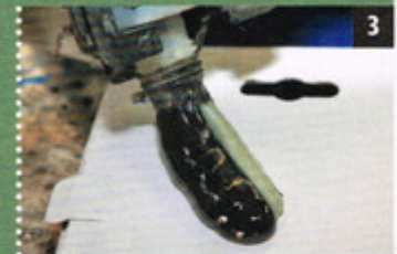
3 Retter in der Not ist nicht Spachtel, sondern 2K-Karosseriekleber
