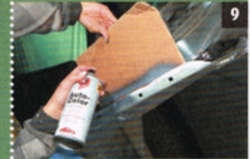
9 Das Audi-Silber kommt aus der Spraydose
