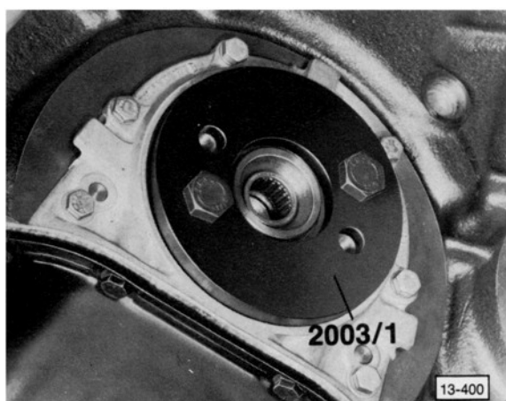
Abb. 8 Dichtring, Schwungradseite einbauen Dichtlippe und äußeren Rand des Dichtringes vor dem Einbauen leicht einölen.
