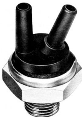
Abb. 10 Thermopneumatisches Ventil prüfen
