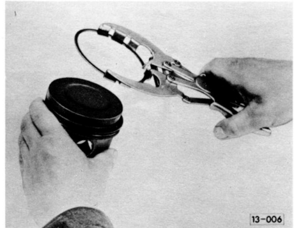
Abb. 10 Kolbenringe aus- und einbauen
