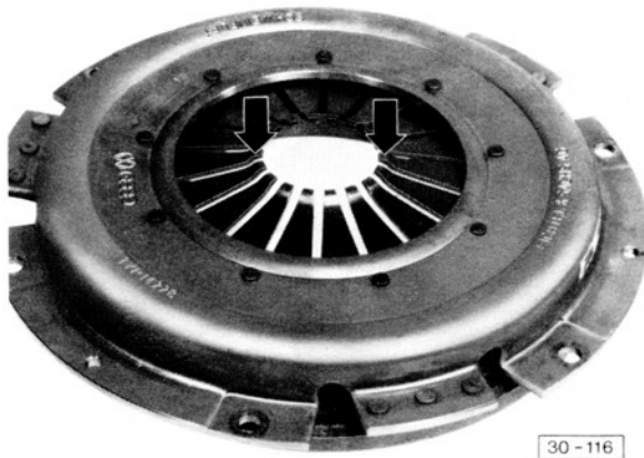
Abb. 2 Druckplatte auf Verschleiß prüfen
