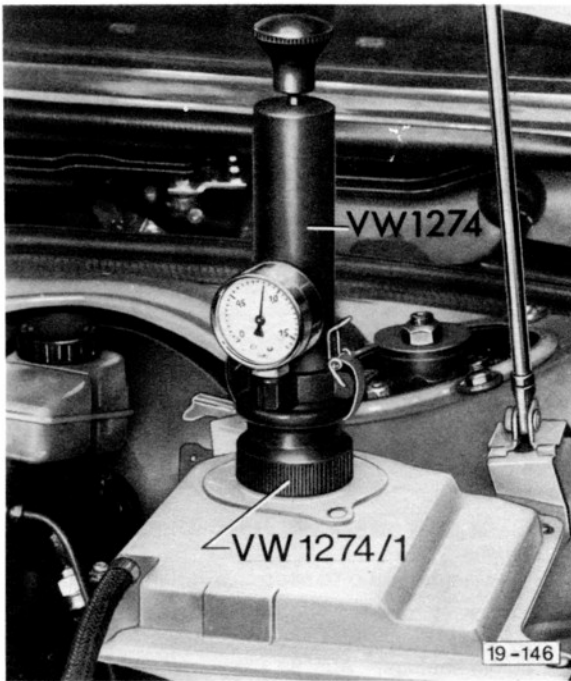
Abb. 1 Kühlsystem – Dichtheit prüfen Nur bei betriebswarmen Motor durchführen. Prüfdruck: 0,8 – 1,0 bar Überdruck.
