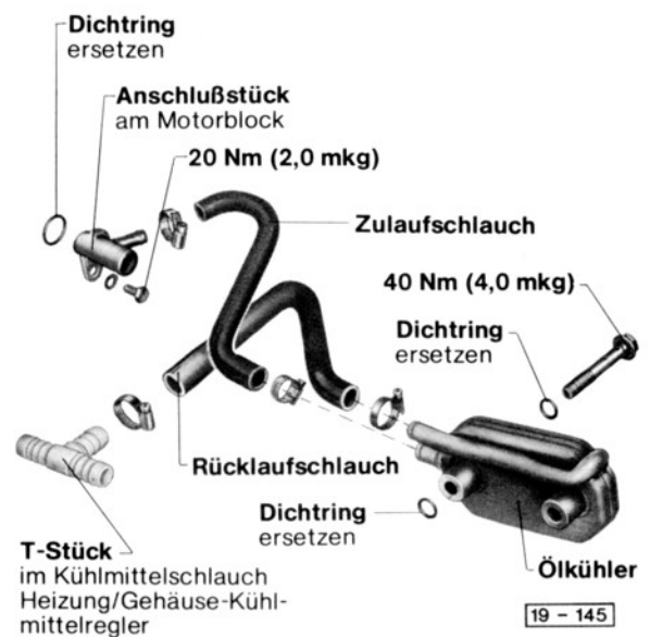
Abb. 5 Zusätzliche Teile des Kühlsystems bei Automatik-Getriebe
