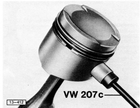
Abb. 5 Kolbenbolzen aus- und eintreiben
