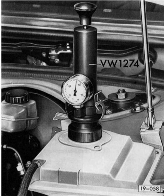
Abb. 1 Kühlsystem – Dichtheit prüfen Nur bei betriebswarmem Motor durchführen. Prüfdruck: 0,8–1,0 bar Überdruck.
