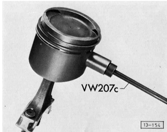
Abb. 5 Kolbenbolzen aus- und eintreiben
