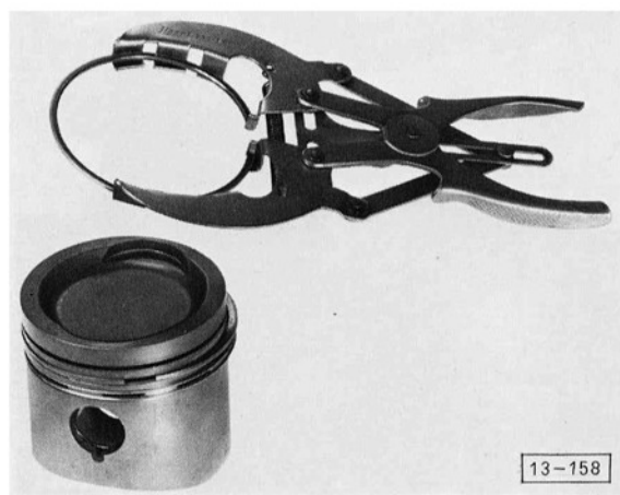
Abb. 9 Kolbenringe aus- und einbauen
