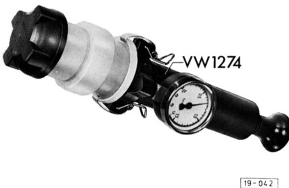
Abb. 2 Überdruckventil im Verschluß prüfen Prüfdruck: 0,9–1,15 bar Überdruck.
