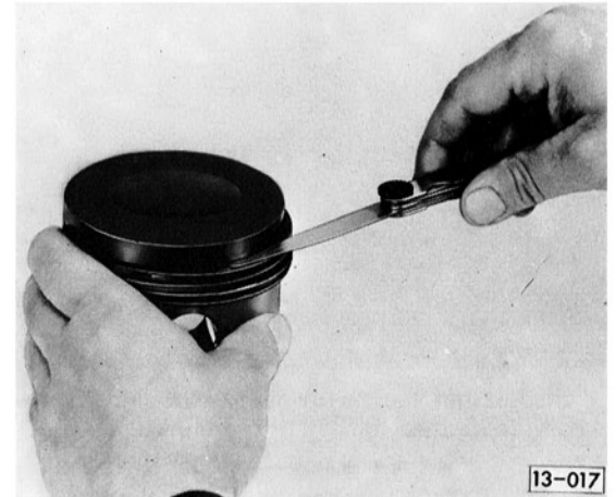
Abb. 6 Kolbenring – Höhenspiel messen Neu: 0,02–0,05 mm. Verschleißgrenze: 0,15 mm.
