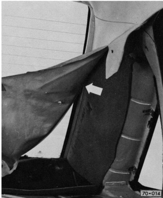
Dachverkleidung hinten am Eckfenster lösen und Keder aus der Klemmleiste drücken.
