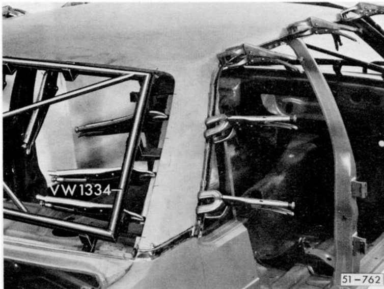
Bild 11: Dach-Neuteil auflegen, ausrichten und anklebmen. Lehre für Rückblickfenster – VW 1334 – einlegen.
