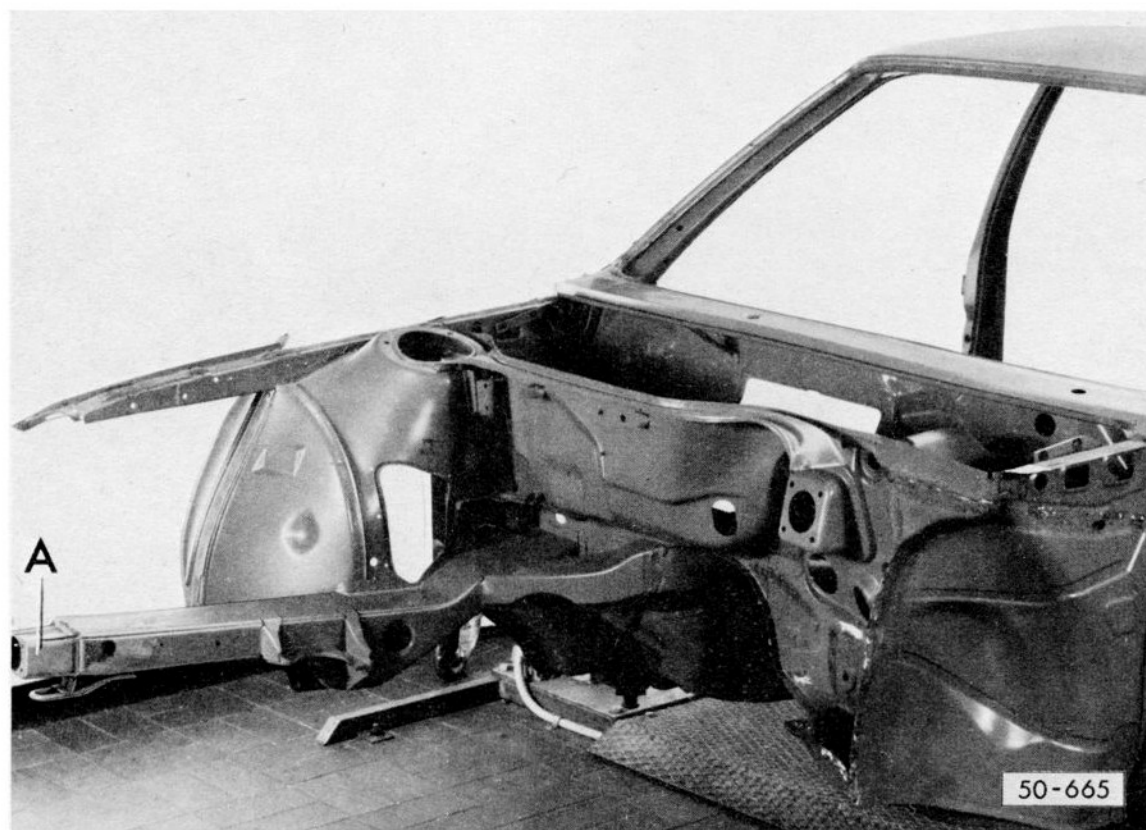
Bild 6: Radhaus Reststücke entfernen
