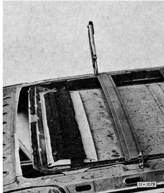
Bild 6: Dachversteifung Neuteil B auflegen, ausrichten, anklemmen
