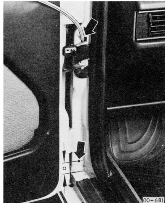
4 Säule I Türkontaktschalter aus- und einbauen. Loch 10 mm Ø über Einstieg – Maß a = 35 mm – bohren.
