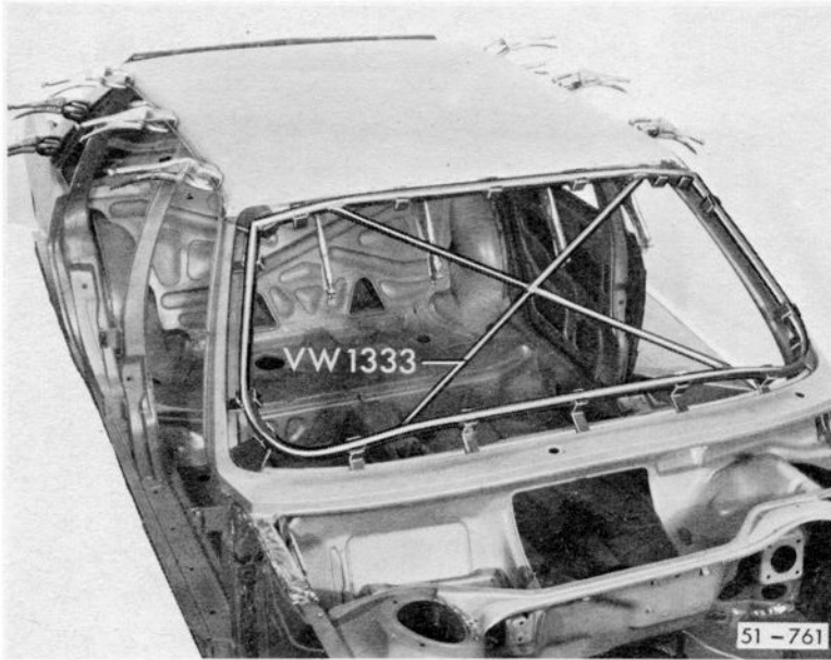
Bild 10: Dach-Neuteil auflegen, ausrichten und anklebmen. Lehre für Windschutzfenster – VW 1333 – einlegen.
