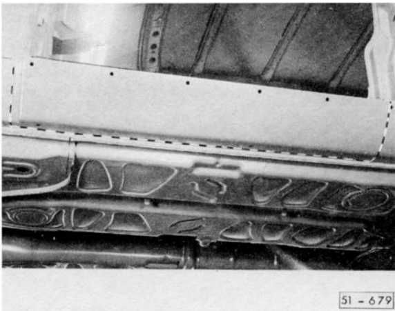
Bild 1, 2: Unterholm außen trennen Druckluftmeißel, Handsäge
