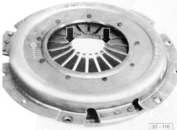
Abb. 2 Druckplatte auf Verschleiß prüfen Enden der Membranfeder auf Einlaufspuren prüfen. Verschleißrillen bis max. 0,3 mm sind zulässig.
