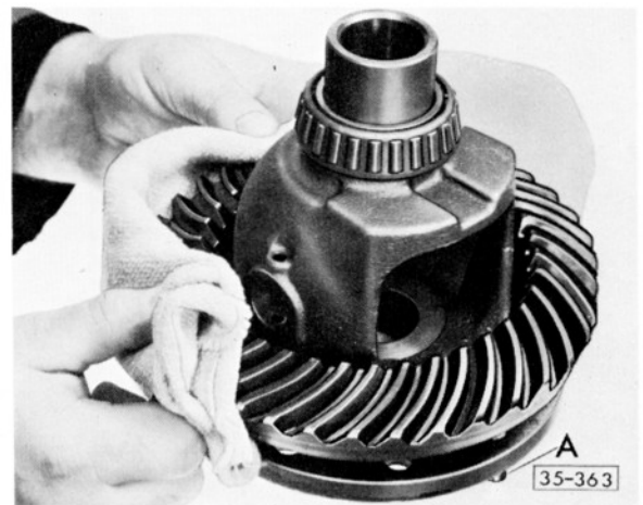
Abb. 8 Tellerrad auf ca. 100° C erwärmen und aufsetzen
