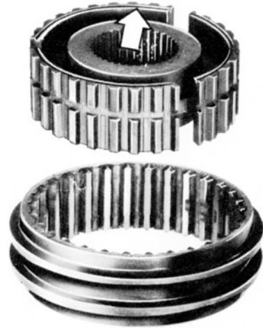
Abb. 3 Schiebemuffe und Synchronkörper für 3. und 4. Gang zusammenbauen.
