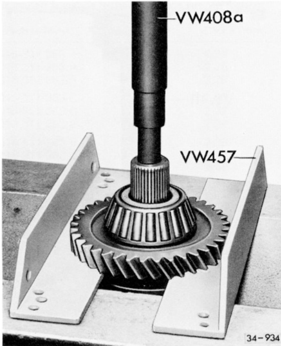
Abb. 1 Innenring/Kegelrollenlager mit Schaltrad für 1. Gang abpressen
