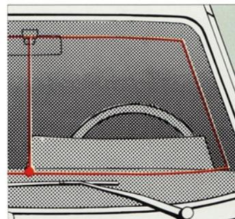
Frontscheibenantenne (Z 051 425). Waschanlagensicher, innen an der Windschutzscheibe montiert.
