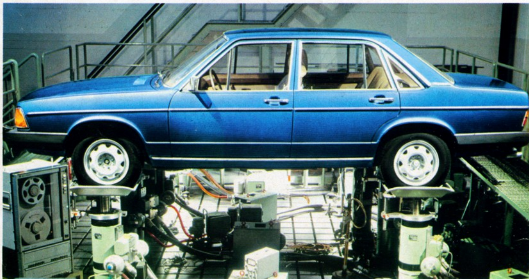
De test op de trilbank komt overeen met langdurig rijden op zeer slechte wegen
