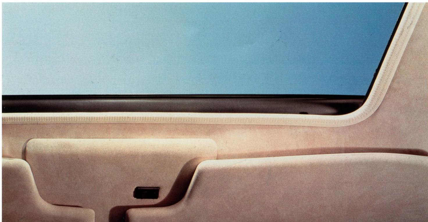
*Schiebe-Ausstelldach, auf Wunsch mit elektrischem Antrieb.*
