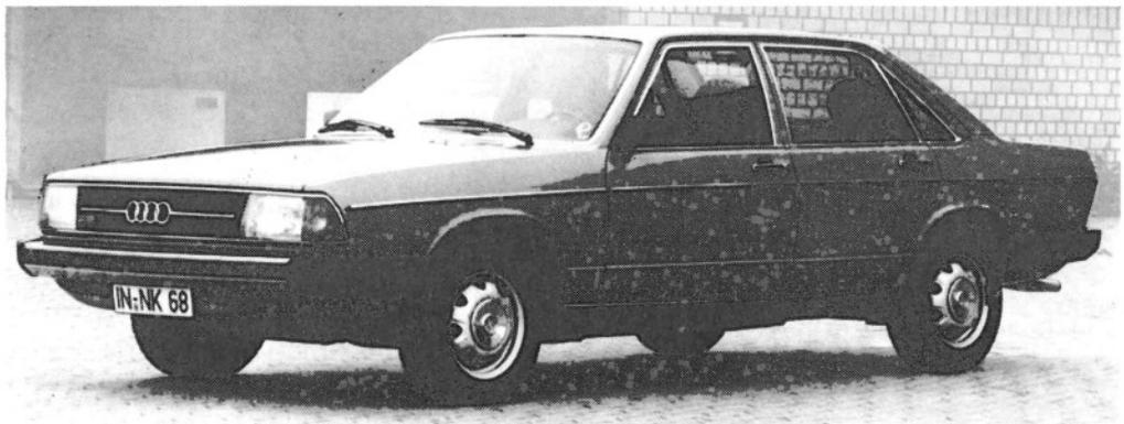
Bild 1. Audi 100 für 1979 mit Fünfzylinder-Einspritzmotor (5E), Vergasermotor (5S) und Dieselmotor (5D) mit 100 kW (136 PS) bzw. 85 kW (115 PS) bzw. 51 kW (70 PS), die Höchstgeschwindigkeiten betragen entsprechend 190 bzw. 177 bzw. 150 km/h
