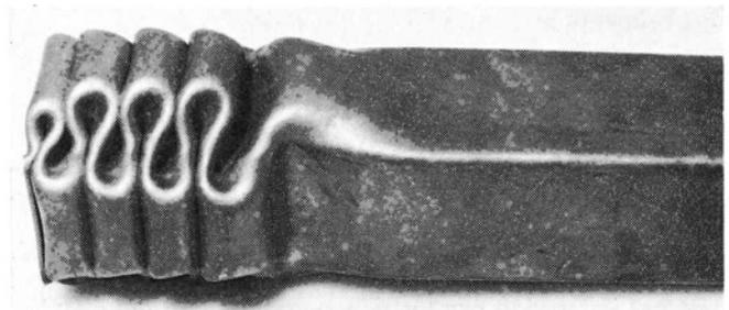
Bild 9. Regelmäßige Faltenbildung durch autogenes Faltenbeulen Rohr  $50 \times 50 \times 1,5 \text{ mm}$ ; Aufprallgeschwindigkeit  $50,3 \text{ km/h}$ ; Kraft  $41\,400 \text{ N}$
