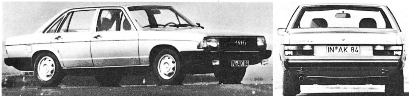
Bild 1 (oben). Der neue Audi 100 in der GL-Ausführung; 1,6-, 2,0- und 2,2-l-Motor mit 85, 115 bzw. 136 PS; 160, 179 bzw. 190 km/h. Der 2,2-l-Motor ist der erste Fünfzylinder-Ottomotor; wie bisher hat der Wagen Vorderradantrieb
